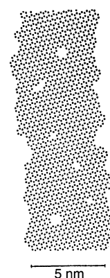
Abbildung 43. Zeichnung einer Modell-Graphenschicht in einer CF mit Fehlstellen. [221] Reproduziert mit freundlicher Genehmigung von Maney Publishing.
